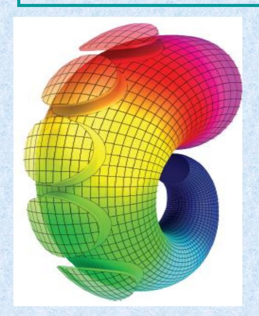
Per il Progetto delle nuove lenti VISION SIMPLY e VISION HD, è stata messa a punto una superficie particolare, che varia con continuità il suo raggio di curvatura in due direzioni, in modo da avvicinarsi il più possibile ai valori del ramo inferiore dell'ellisse di Tscherning (la parte trovata da Ostwalt)
